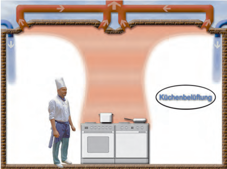
Abb. 12: Mischströmung: Die Zuluft wird mit hoher Geschwindigkeit von der Decke in den Raum ein-geblasen
