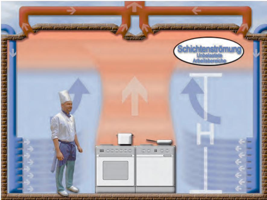
Abb. 14: Schichtenströmung mit bodennahen Luftdurchlässen
