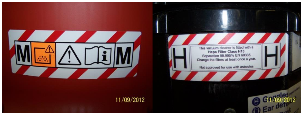
Slika 4: Oznaka na sesalnih napravah razredov M in H (vir: HSE, GB)
