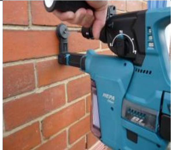
Dobra praksa – uporaba ročnega vrtalnika z vgrajeno kaseto (HSE, GB)
