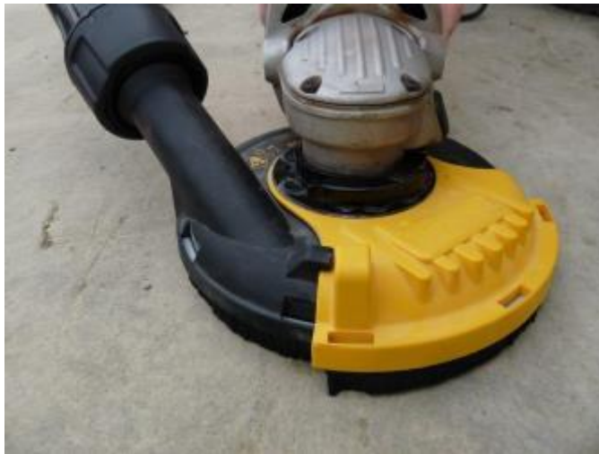
Slika 3: Brusilnik z odsesavanjem pri orodju (vir: HSE, GB)
