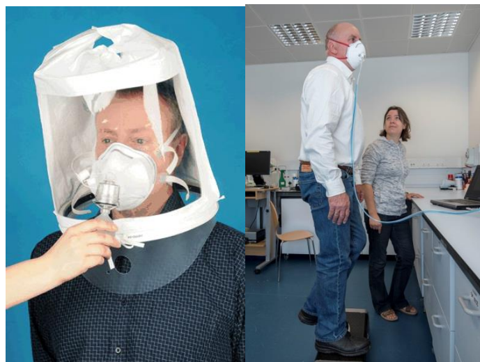
Slika 6: Kvalitativen in kvantitativen preskus prileganja (vir: HSE, GB)
