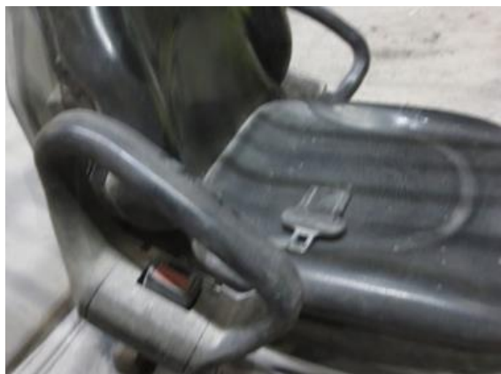
Slika 7: Odrezan vtičnik varnostnega pasu na viličarju
